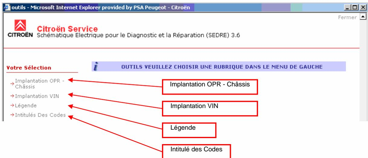
➔ **Implantation du n°OPR-Châssis**. pour chaque véhicule sélectionné apparait l'emplacement de la plaque du n°d'OPR.
