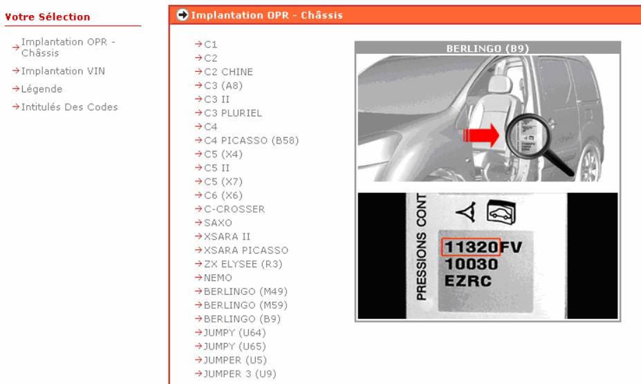
➔ **Implantation VIN** : pour chaque véhicule sélectionné, la flèche vous indique l'emplacement du VIN.
